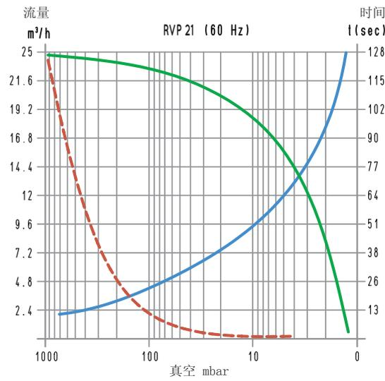
要计算抽空 $V_1$ 体积的时间，可用公式： $t_1 = \frac{t \times V_1}{6}$
